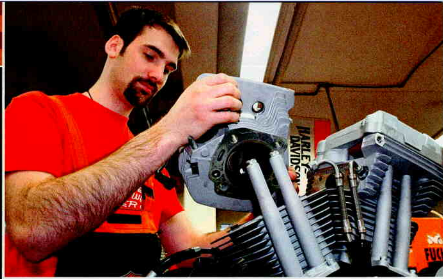
Sebastian bei der Arbeit: Die Köpfe wurden einer Intensivkur unterzogen. Die Kanäle wurden bearbeitet und die Brennräume modifiziert
