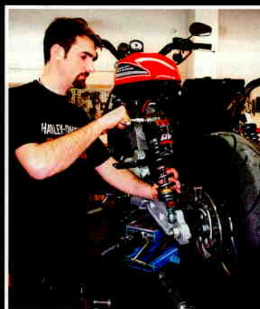
Alles anders: Auspuff, Federbeine, Gabelbrücke. Am Schluss wurde auf dem Prüfstand ein neues Mapping erstellt (u.)
