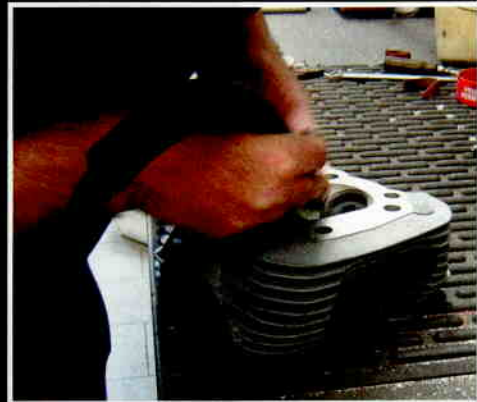
Feintuning: Nachbearbeitung der Ventilsitzringe, Auslitern der Brennräume. Bei Bedarf wird nachgeschliffen (o.)
