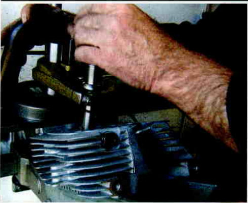
Feintuning: Nachbearbeitung der Ventilsitzringe, Auslitern der Brennräume. Bei Bedarf wird nachgeschliffen (o.)
